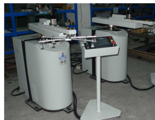
冲压上下料机器人装配现场 Assembly site of press load/unload robot
