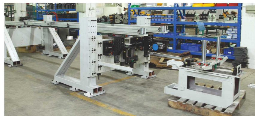
冲压机械手装配现场 Assembly site of press transfer
